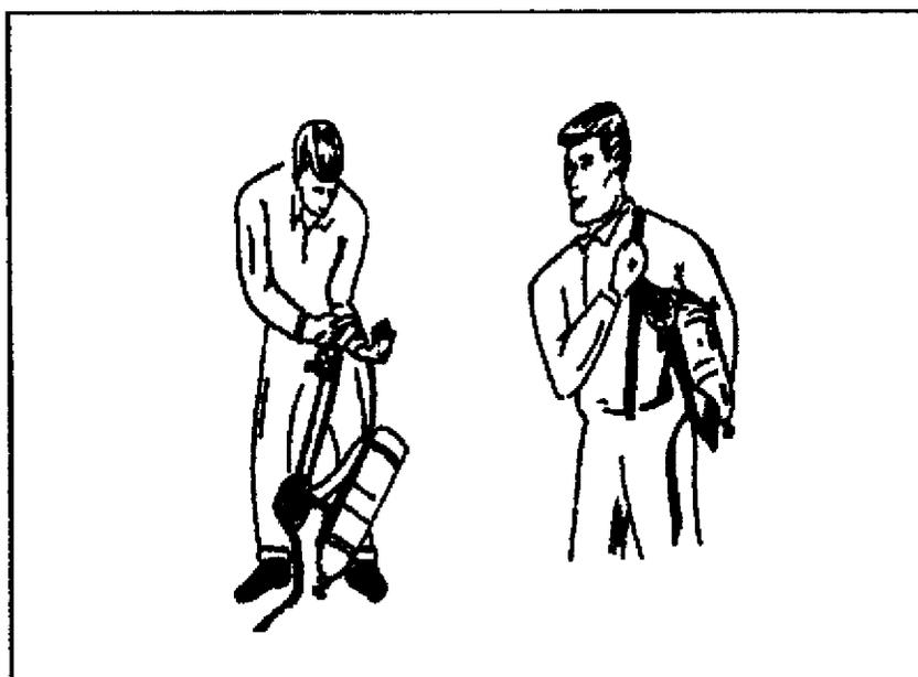
**Figura 25** Colocación del equipo en forma de chaqueta.
